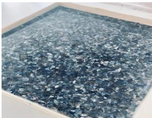
3. Metemos los moldes con la mezcla al horno unos minutos. Tras ello, dejamos secar y colocamos la losa definitiva en el suelo de la casa.
