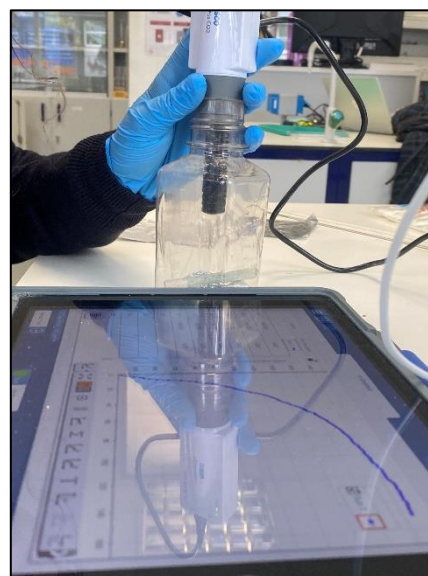
Imagen 9 Registro del nivel de dióxido de carbono en el interior de la botella debido a la combustión del cigarrillo. Elaboración propia.
