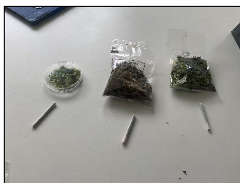
Imagen 7 Ejemplo de un lote, con cada especie de hoja, realizamos 5 cigarrillos de cada una de ellas para poder contrastar los datos entre ellas y con los cigarrillos control (planta de tabaco). Elaboración propia
