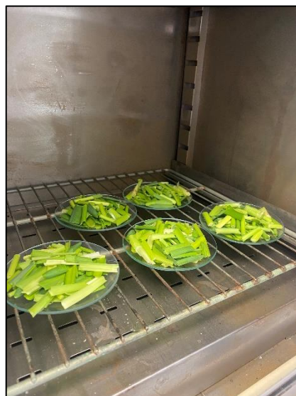
Imagen 4 Localización de las placas Petri en el interior de la incubadora del colegio. Proceso de deshidratación de las hojas. Elaboración propia
